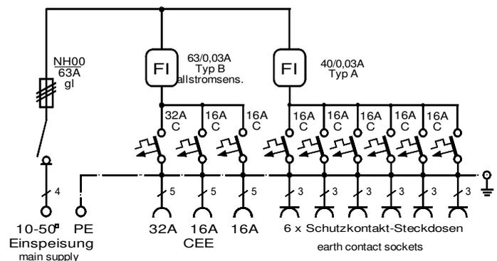
**ELEKTRA - Verteilerschrank im Gehäuse aus verzinktem Stahlblech, pulverbeschichtet RAL 6018, bestückt mit:**
