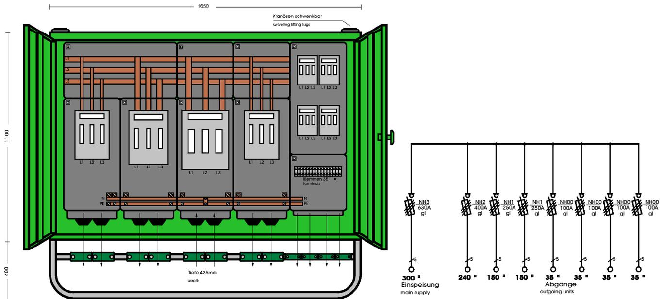
**ELEKTRA - Hauptverteilerschrank im Gehäuse aus verzinktem Stahlblech, pulverbeschichtet RAL 6018, bestückt mit:**
