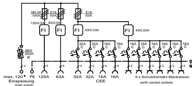
**ELEKTRA - Verteilerschrank im Gehäuse aus verzinktem Stahlblech, pulverbeschichtet RAL 6018, bestückt mit:**
