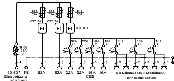
**ELEKTRA - Verteilerschrank im Gehäuse aus verzinktem Stahlblech, pulverbeschichtet RAL 6018, bestückt mit:**
