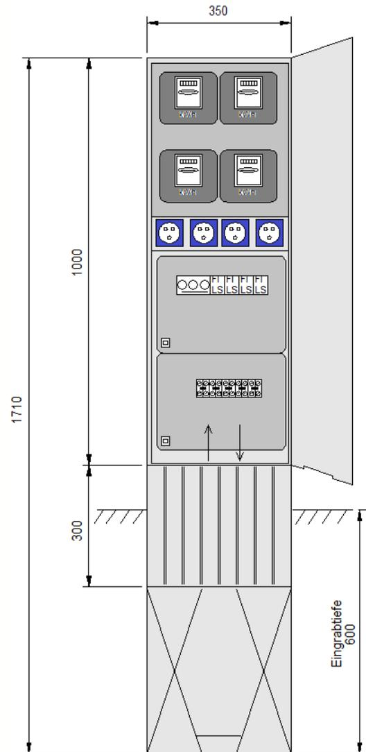
**ELEKTRA** - Stromverteiler-Schrank aus glasfaserverstärktem Polyester (GFK) mit angespresstem Sockel und Regenschutzdach. Schutzart IP 44, Farbe hellgrau; Türe mit Sicherheitsschloss.
