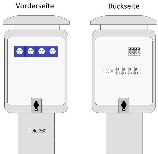
**ELEKTRA** - Stromverteiler im Gehäuse aus glasfaserverstärktem Polyester (GFK), Farbe hellgrau, abschließbare Klarsichtdeckel aus Polycarbonat, Lampenfassung E 14 für Orientierungsbeleuchtung, Schutzart IP 44
