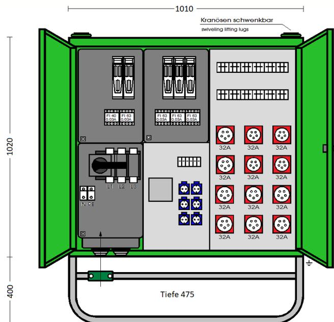
**ELEKTRA** - Verteilerschrank im Gehäuse aus verzinktem Stahlblech, pulverbeschichtet RAL 6018, bestückt mit:
