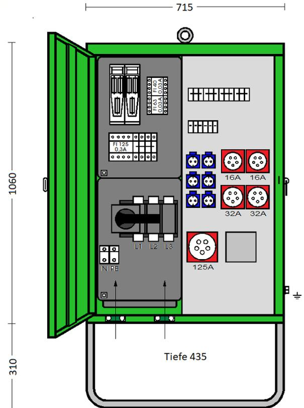
**ELEKTRA** - Verteilerschrank im Gehäuse aus verzinktem Stahlblech, pulverbeschichtet RAL 6018, bestückt mit:
