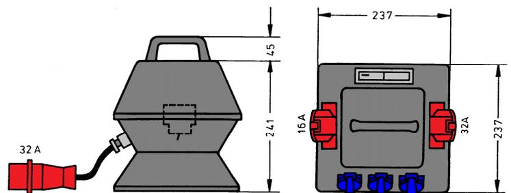
**ELEKTRA** – Steckdosenverteiler im Vollgummigehäuse mit Tragegriff, bestückt mit:
