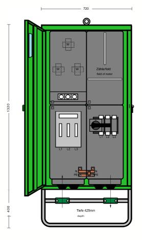
ELEKTRA - Anschlussschrank im Gehäuse aus verzinktem Stahlblech, pulverbeschichtet RAL 6018, bestückt mit:
