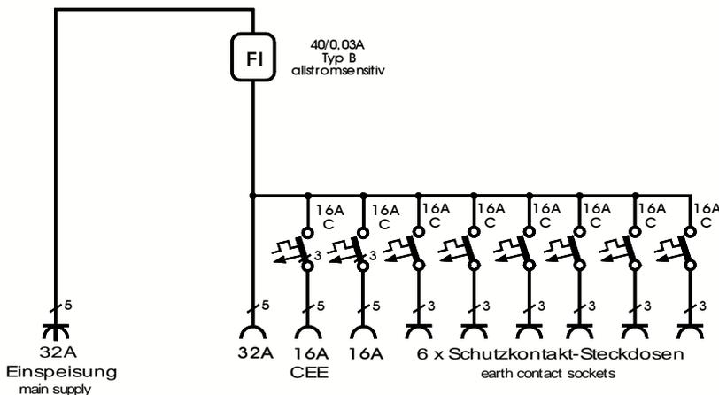
**ELEKTRA** – Steckdosenverteiler im Kunststoffgehäuse mit Tragegriff,
