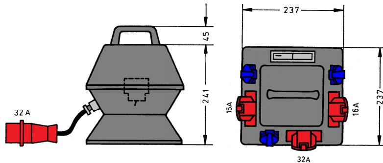
**ELEKTRA** – Steckdosenverteiler im Vollgummigehäuse mit Tragegriff, bestückt mit:
