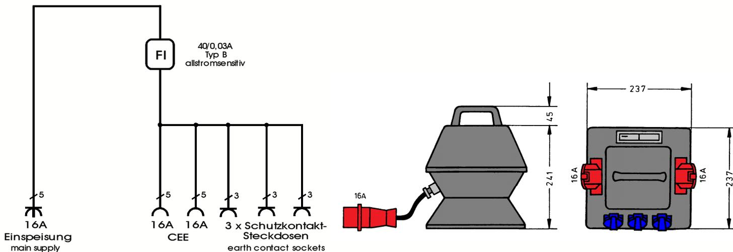
**ELEKTRA** – Steckdosenverteiler im Vollgummigehäuse mit Tragegriff, bestückt mit:
