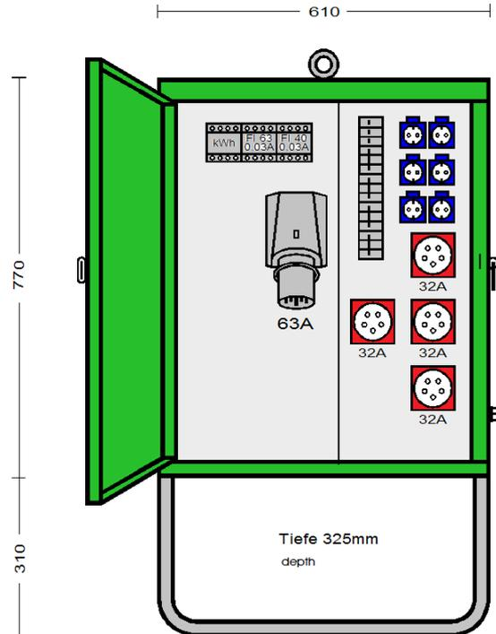
**ELEKTRA** - Endverteilerschrank im Gehäuse aus verzinktem Stahlblech, pulverbeschichtet RAL 6018, bestückt mit:
