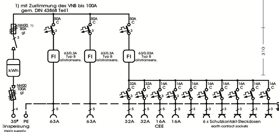
**ELEKTRA** - Anschlussverteilerschrank im Gehäuse aus verzinktem Stahlblech, pulverbeschichtet RAL 6018, bestückt mit:
