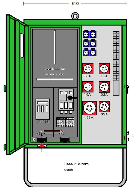
**ELEKTRA** - Anschlussverteilerschrank im Gehäuse aus verzinktem Stahlblech, pulverbeschichtet RAL 6018, bestückt mit:
