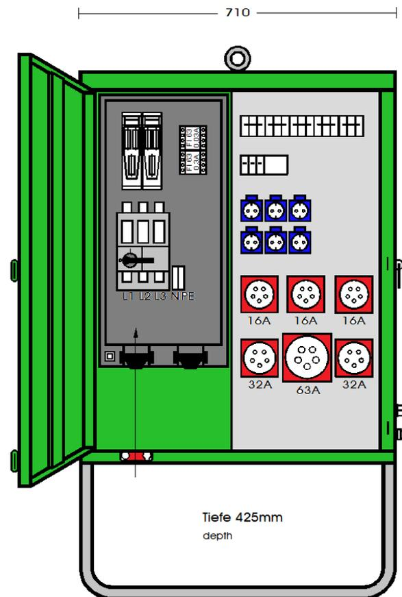
**ELEKTRA** - Verteilerschrank im Gehäuse aus verzinktem Stahlblech, pulverbeschichtet RAL 6018, bestückt mit:
