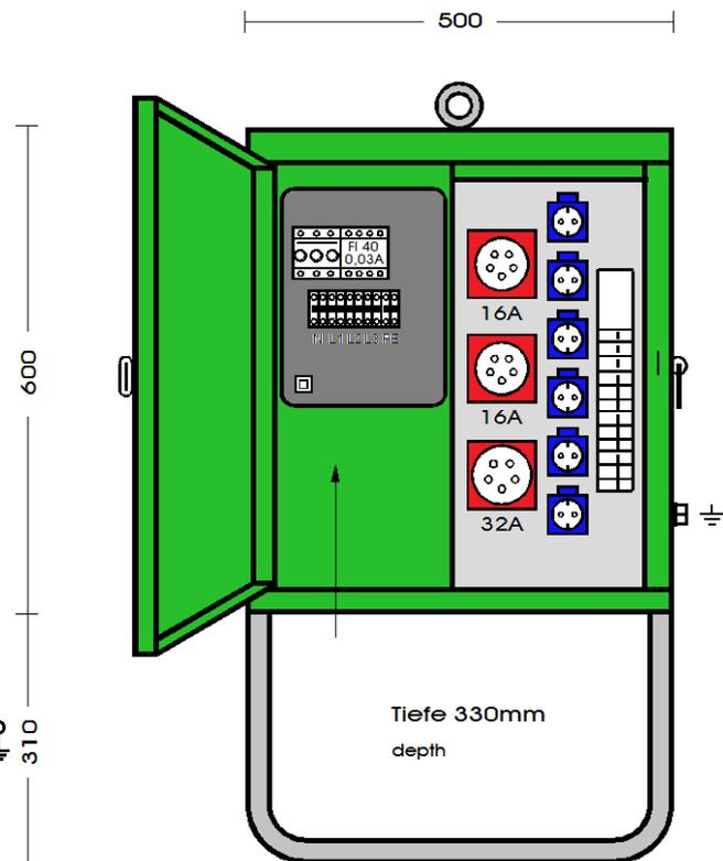
**ELEKTRA** - Verteilerschrank im Gehäuse aus verzinktem Stahlblech, pulverbeschichtet RAL 6018, bestückt mit:
