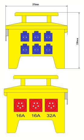
ELEKTRA – Steckdosenverteiler im Kunststoffgehäuse mit Tragegriff, bestückt mit:
