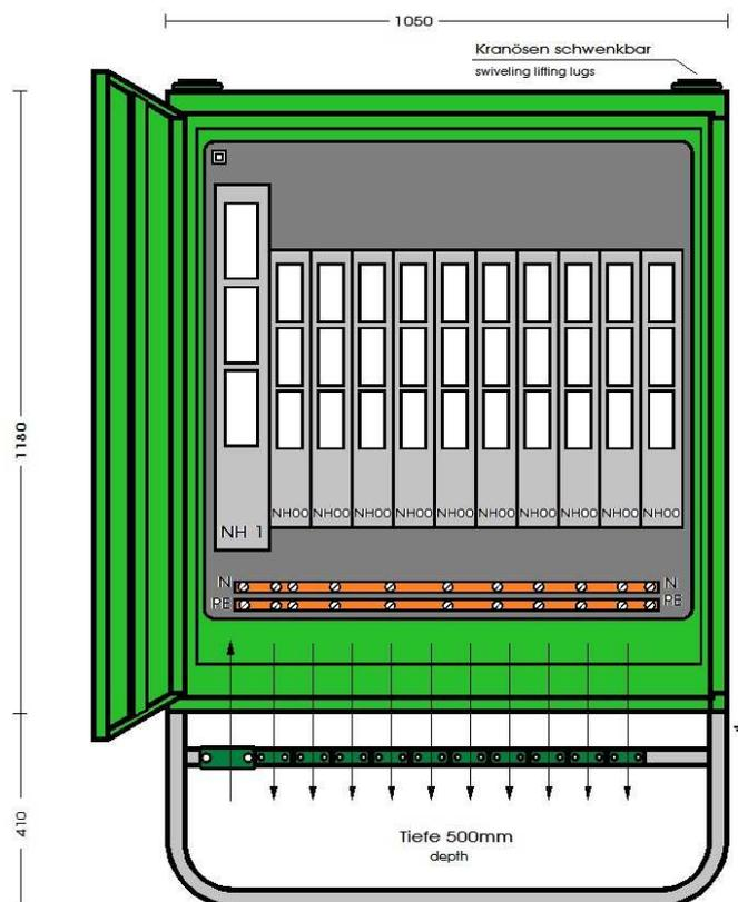
**ELEKTRA** - Gruppenverteilerschrank im Gehäuse aus verzinktem Stahlblech, pulverbeschichtet RAL 6018, bestückt mit:
