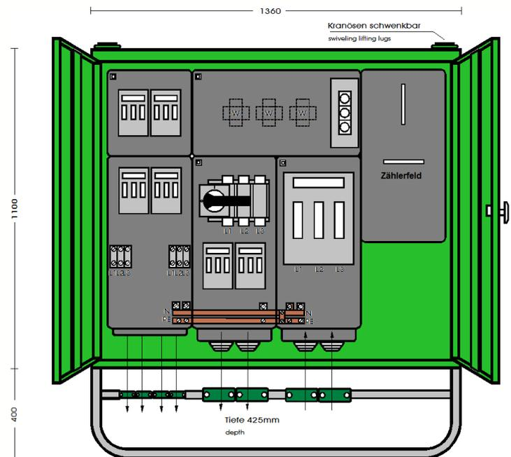
**ELEKTRA** - Anschlusschrank im Gehäuse aus verzinktem Stahlblech, pulverbeschichtet RAL 6018, bestückt mit:
